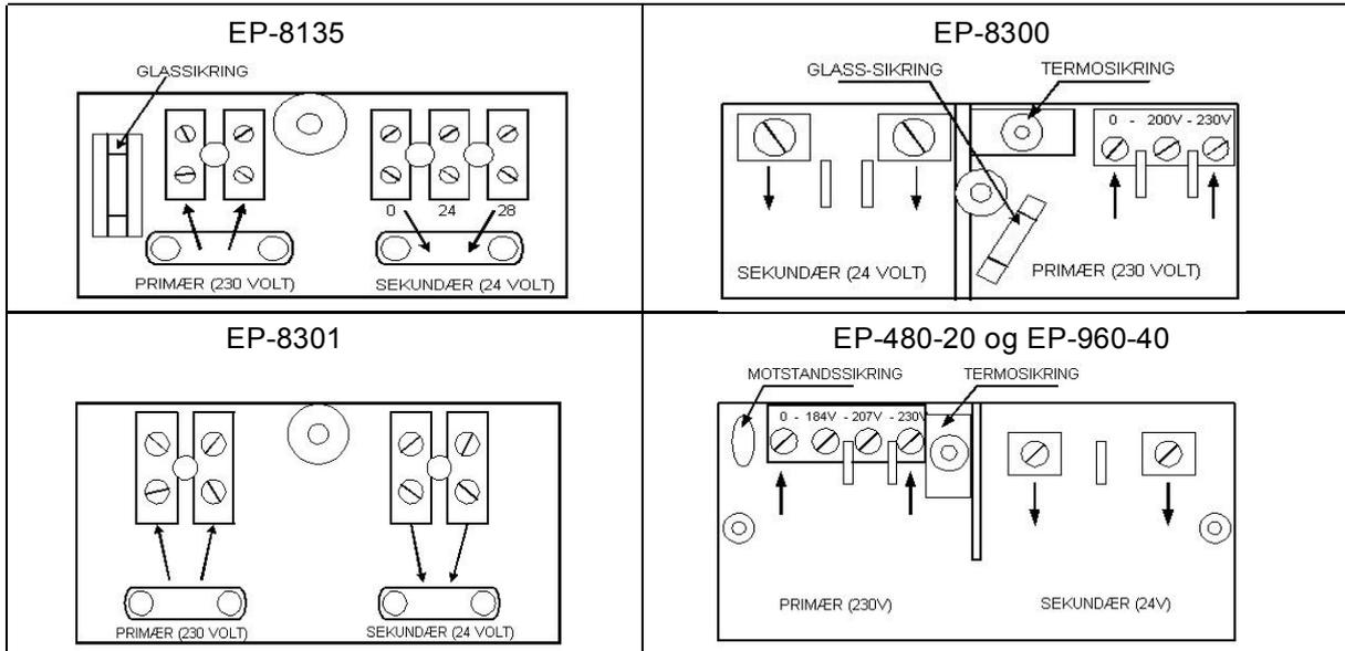
Ovenstående transformatorer er utstyrt med vendebryter utvendig ved tilkoblingsende. Benytt mynt eller skrutrekker for å veksle mellom høyere og lavere temperatur.
